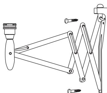
①本体を付属のネジ（2本）で壁面の補強材
