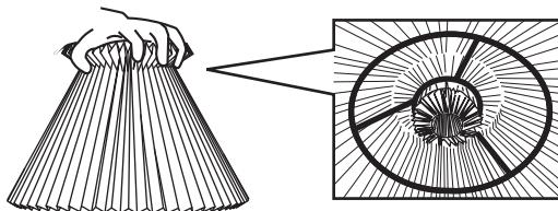
③シェード上面をすぼめて持ったまま、シェード内側の折り返し部分を灯具のフレームに引掛けるように固定します。
