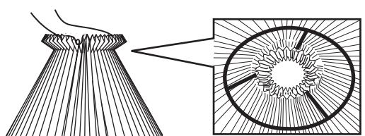
④ゆっくりと手を離せば、シェードの折り返し部分がフレームのリングに引っ掛けられ固定されます。
