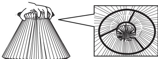
③シェード上面をすばめて持ったまま、シェード内側の折り返し部分を灯具のフレームに引掛けるように固定します。
