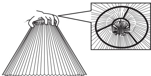
③シェード上面をすぼめて持ったまま、シェード内側の折り返し部分を灯具のフレームに引掛けるように固定します。
