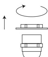
②本体のソケットに付属している取付用リングを回して外してください。
