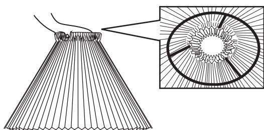
④ゆっくりと手を離せば、シェードの折り返し部分がフレームのリングに引っ掛け固定されます。
