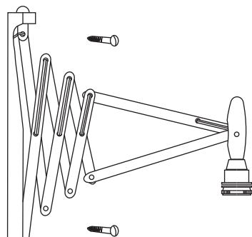
①本体を付属のネジ（2本）で壁面の補強材のある位置に取り付けてください。
