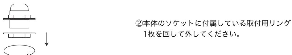
②本体のソケットに付属している取付用リング1枚を回して外してください。
