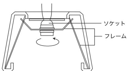
③ ソケットにシェードのフレームを取り付け、取付用リングを再度ソケットに締め込みます。
