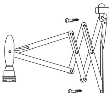
① 本体を付属のネジ（2本）で壁面に取り付けてください。
