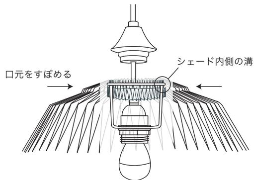
③シェード上部を閉じ、取り付けた電球（ランプソケット側）のフレームをシェード内側の溝にはめ込みます。
