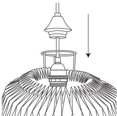
②シェード上部を広げ、取り付けた電球（ランプソケット側）をシェード上部から下部へ通します。
