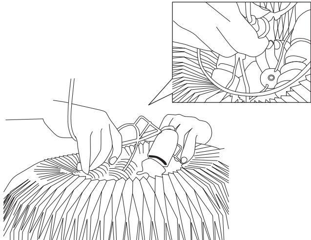
③電球を2つ取り付けた後、フレームを元に戻します。
