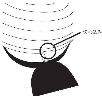
④ シェードを木製フレームとスチールの間に差し込みます。
