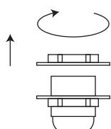
②本体のソケットに付属している取付用リング1枚を回して外してください。
