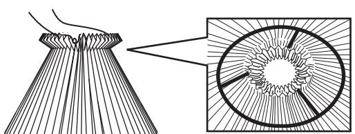
④ゆっくりと手を離せば、シェードの折り返し部分がフレームのリングに引っ掛けられ固定されます。
