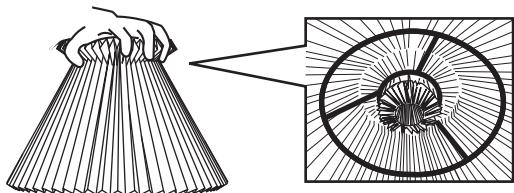
③シェード上面をすぼめて持ったまま、シェード内側の折り返し部分を灯具のフレームに引っ掛けるように固定します。
