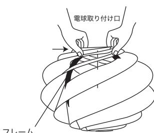
⚠ シェードはそれぞれのフレームがアクリルリングにはめ込んで形成されています。はめ込みがわずかにズレたり緩くなると電球取り付け口が狭まり、シェードの取り付けができない、もしくは取り付けづらくなる原因になります。
