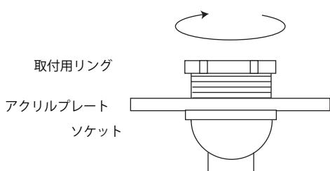
③ソケットに付属している取付用リングを回して外してください。
