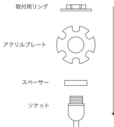
③ソケットに付属している取付用リングを回して外してください。
