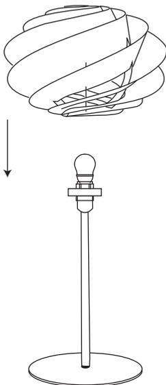
⑥シェードを被せます。その際にアクリルプレートの上に載せるのではなくシェードをゆっくりとまわしてアクリルプレートの溝にはめ込み、さらにシェードを少しまわして本体からシェードが外れないようにしてください。
