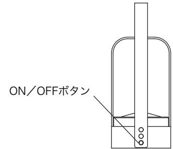
充電ケーブル差入口の反対側にあるボタンで、ライトのON・OFFを操作できます。
